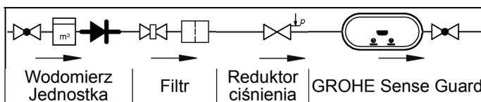
Po podłączeniu GROHE Sense Guard do napięcia sieciowego urządzenie jest objęte ochroną przed wyciekami. Jeśli GROHE Sense Guard nie ma dostępu do energii elektrycznej, nie można zamknąć systemu doprowadzenia wody.
