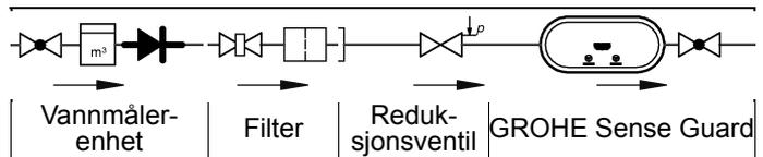
Straks GROHE Sense Guard er koblet til strømmettet, er lekkasjebeskyttelsen i drift.
