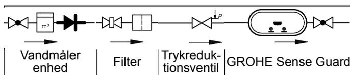
Så snart GROHE Sense Guard er sluttet til netspændingen, er lækagebeskyttelsen etableret.
