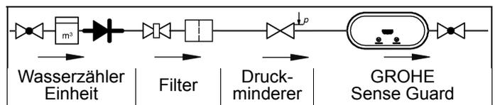
Sobald der GROHE Sense Guard an die Netzspannung angeschlossen ist, ist der Leckageschutz gegeben.
