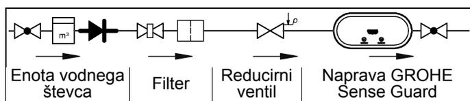
Takoj ko je naprava GROHE Sense Guard priključena na omrežno napetost, zaščita proti puščanju deluje. Če naprava GROHE Sense Guard ni priključena na dovod električne energije, ne more prekiniti dotoka vode.
