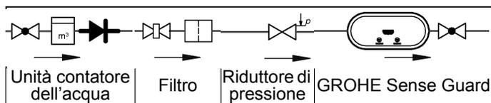
La funzione di rilevamento perdite si attiva non appena GROHE Sense Guard viene collegato alla rete di corrente. Se GROHE Sense Guard non è collegato alla rete di corrente non può più chiudere l'erogazione dell'acqua.
