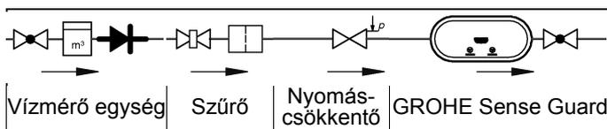
Amint a GROHE Sense Guard csatlakoztatva van a hálózati feszültségre, működik a szivárgás elleni védelem.
